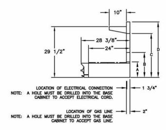
A - ISLAND TRIM HEIGHT - 9 1/16" B - 6" STANDARD BACKGUARD HEIGHT - 14-9/16" C - 17" BACKGUARD HEIGHT - 25-9/16" D - HIGH SHELF BACKGUARD HEIGHT - 32 5/16"
